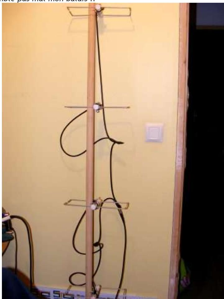
Les premiers relevés que j'ai effectué avec le ROS mètre incorporé au 817 mon juste permit de constaté que celui ci semble être bon, et quil correspond a la simulation de Mmana, puisque le 817 affiche la première barre du ROS metre a 1.4 et que j'ai bien 1.4 a 427mhz et a 437 mhz entre les deux le barre graphe n'affiche rien cool quel joie!!
