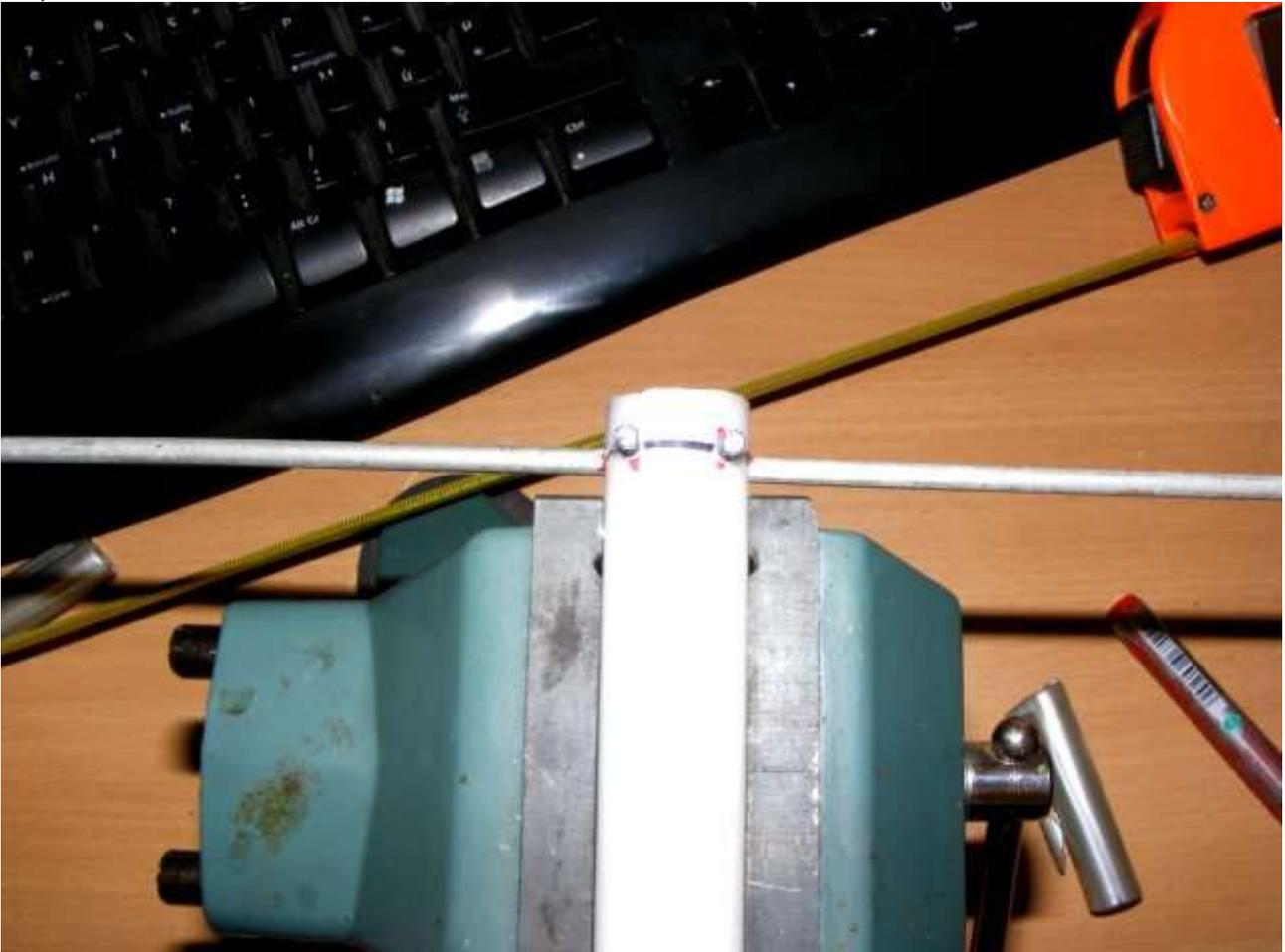
*Pour le grand élément le plier que d'un cote pour le moment et le rentrer dans le boom*
