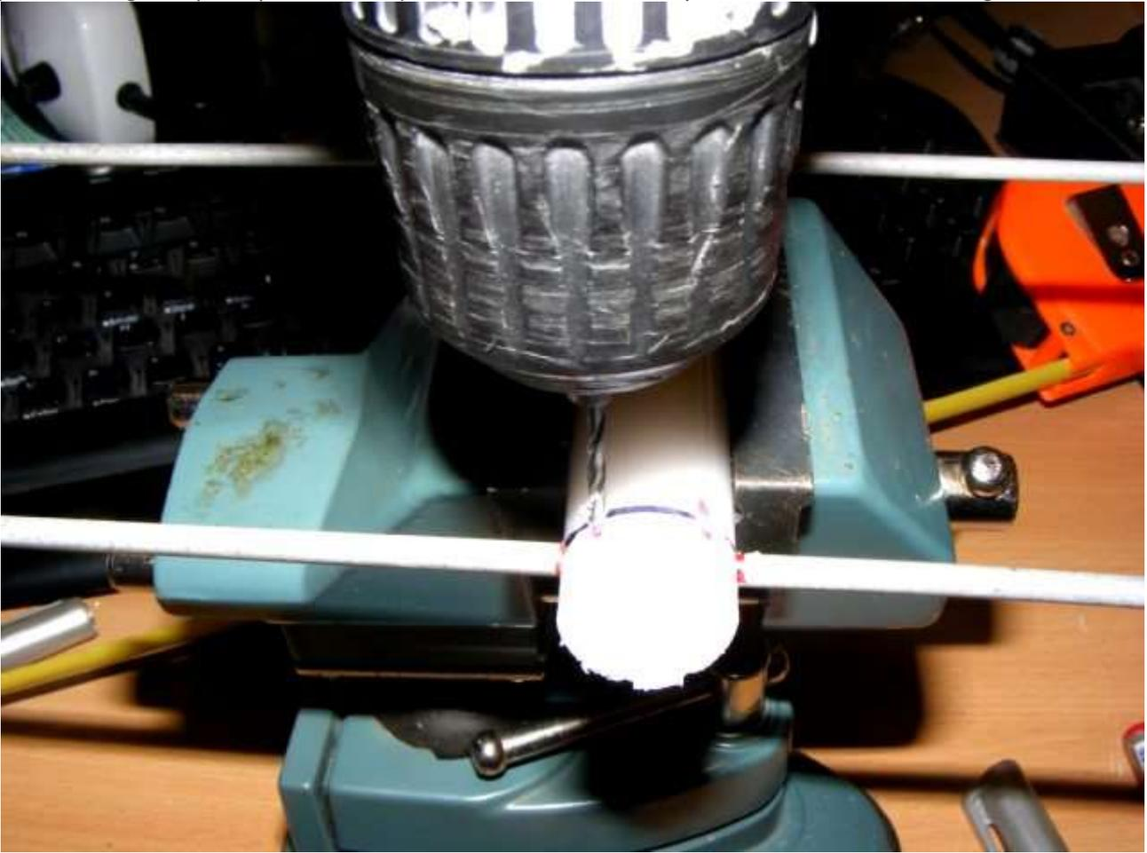
*Mettre deux vis de maintiens et leur couper la tete des quelles sont bien serrées, en faite je serre jusqu'à ce que la tête des vis cassent*
