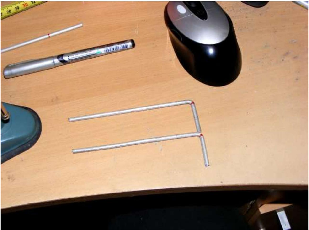
*Repérage des position a 7mm des elements radiateur( les petits) dans le boom qui fait 20mm ca permet d'avoir un espace de  $20-2 \times 7=6$ mm entre les éléments moins les bavure*
