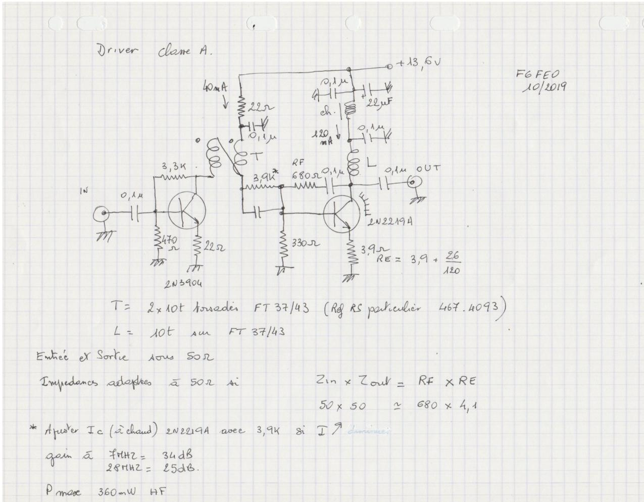
la capa ajustable du filtre en T est céramique et la capa fixe est au mica
